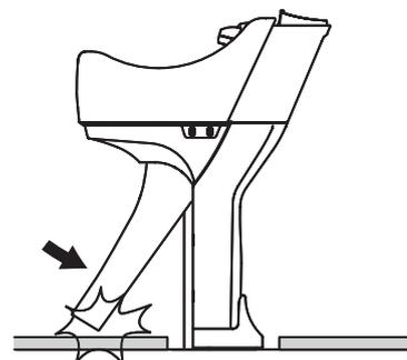
○床面仕上げがタイル等の素材の場合、NSS MINON WALL 本体取付時のボルト締め込みにより、「割れ」が発生します。この場合、製品固定位置図および型紙を参考に、取付部分は合板、モルタル等の素材に変更してください。
